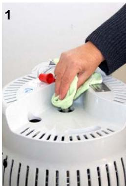
Entfernen Sie die Schutzkappe vom Füllanschluss der Reserve. Wischen Sie vor dem Füllen das Füllfach der Reserve mit einem fusselfreien Lappen sauber und trocknen Sie die Füllanschlüsse von Reserve und Portable.
