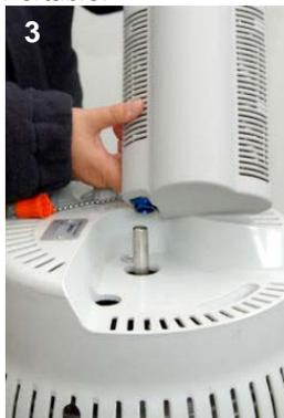
Setzen Sie das Portable behutsam senkrecht auf den Füllanschluss der Reserve. Dazu gegebenenfalls die Gabel des Auslösemechanismus\* etwas absenken.
